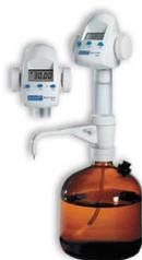
Устройство для дозирования жидких сред Biotrate (насадка на бутыл) - современный цифровой титратор и дозатор, обеспечивающий точную, удобную и безопасную работу.
