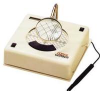
Быстрый и эффективный подсчёт количества колоний микроорганизмов на чашках Петри. Использование автоматического контактного стержня значительно упрощает подсчёт: с его помощью соответствующая колония помечается, и электронный счётчик автоматически переходит к следующей.
