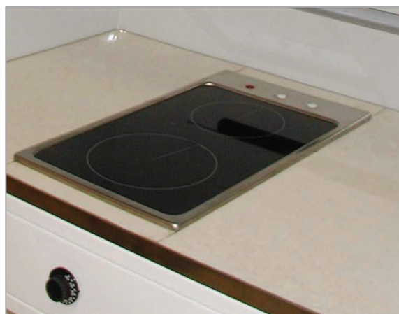
Нагревательная плита в вытяжном шкафу «Квадро»
